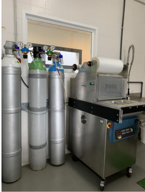
Envasadora termoformadora apta para MAPs - Tecnotrip Modelo TSB-A-100-CD
